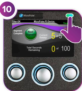
10 治療が完了したら、このボタンを押して**[Standby (スタンバイ)]**モードにします(レーザーを無効にします)。
