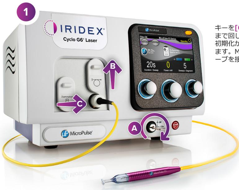
キーを[ON (オッケー)]まで回します。初期化が完了するまで待ちます。MicroPulse P3プロローブを接続します。
